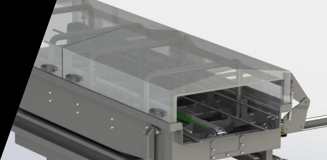
La laveuse est une machine qui lave les cages à poulets de façon automatique. Elle est munie d'un filtre gravitaire haute capacité.
