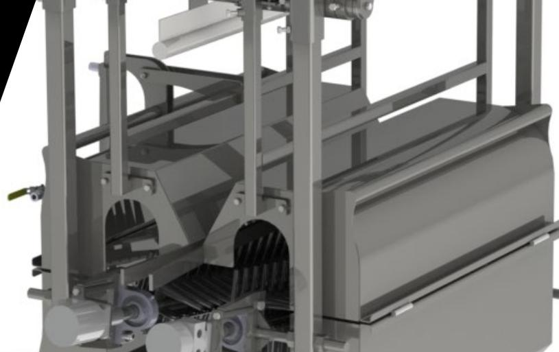
Le décroche pattes est une machine qui sert à décrocher les pattes de poulet qui restent sur le crochet. Le système fonctionne à l'aide de deux moteurs hydrauliques (moteurs électriques également disponibles). L'équipement est muni d'un système d'ajustement de la hauteur par rapport aux rails.
